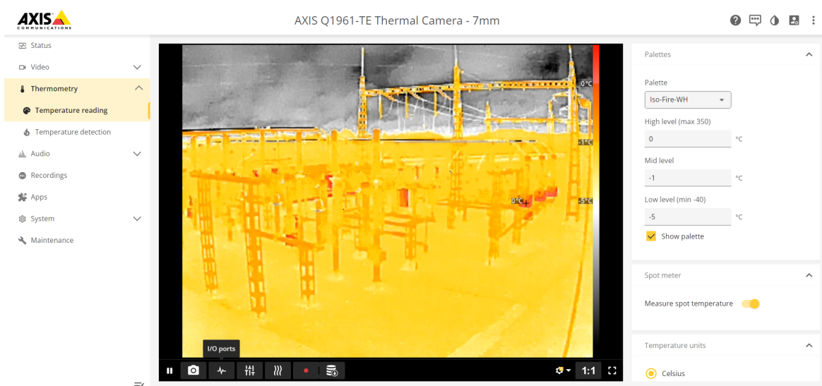
Screenshot von einer AXIS Q1961-TE Thermal Camera. Der Benutzer hat auf einen bestimmten Punkt geklickt, um dessen Temperatur anzuzeigen.
