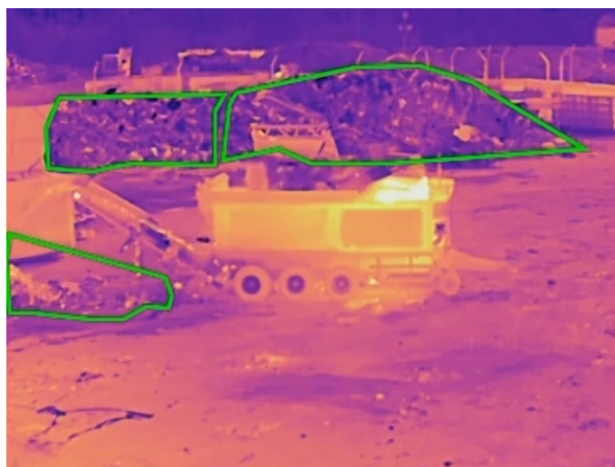
Eine thermometrische Kamera löst einen Alarm aus, sobald die Temperatur im Erfassungsbereich einen benutzerdefinierten Grenzwert überschreitet. Dieser Anwendungsfall ist eine Recyclinganlage, bei der die Erfassungsbereiche (grüne Umrandungen) auf große Abfallhaufen mit hoher Brandgefahr konzentriert sind.
