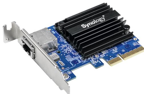
Mit einem RJ-45-Anschluss und Unterstützung für IEEE 802.3an/bz (10GBASE-T/NBASE-T) und 802.3x ermöglicht Ihnen die E10G18-T1 die reibungslose Migration zu einer 10GbE-Netzwerkumgebung mit Ihrer vorhandenen Infrastruktur. Die E10G18-T1 unterstützt Abwärtskompatibilität und Autonegotiation zwischen Datenraten von 10 GBit/s, 5 GBit/s, 2,5 GBit/s, 1 GBit/s und 100 MBit/s und ist die kostengünstige Lösung für kleine Unternehmen und Privatanwender, um Engpässe bei der Datenübertragung zu überwinden.
